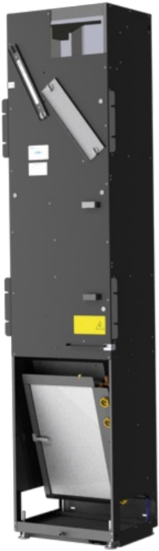
Appareil de soufflage et d'extraction d'air vertical FSL-V-ZAB avec échangeur thermique et récupérateur de chaleur. jusqu'à 42 l/s jusqu'à 150 m 3 /h B: 396 mm H: 1 800 mm T: 319 mm
