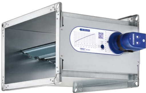
Régulateur CAV type EN pour des débits plus élevés 40 - 3,360 l/s 144 - 12 096 m 3 /h B: 200 - 600, H: 100 - 600 mm \Delta p : 50 - 1,000 Pa Étanchéité du caisson conforme à la norme EN 1751, classe C
