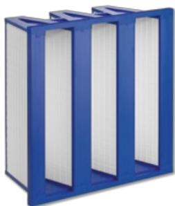
Lorsqu'un filtre U16, avec une efficacité de 99.99995 %, est exposé à 2 millions de particules, seule une unique particule ne sera pas filtrée. Par comparaison, un filtre H13 (99.95% d'efficacité) est perméable à 1000 particules, et un filtre M6 (50% d'efficacité) l'est à un million de particules. Les filtres absolus sont soumis à des tests d'efficacité avant la livraison.
