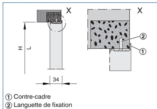
**Grille de ventilation à fixation par vis dissimulées**
