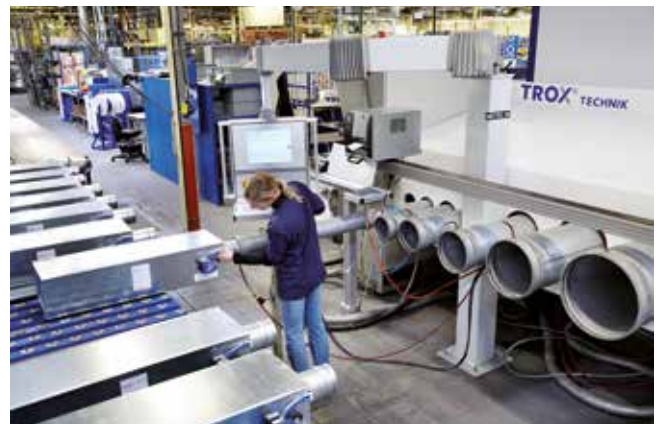
Fabrication, inspection et ajustement des régulateurs de débit en usine
