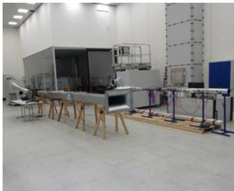
Installations d'essais suivant la norme EN 12589 : tolérance et réponse de la régulation, perte de pression, caractéristiques selon les différentes conditions de soufflage, maître-esclave, etc.
